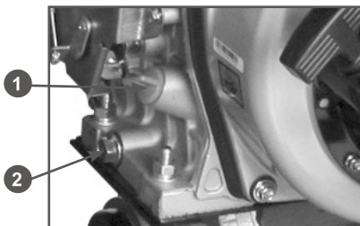
Рис. 10 Проверка уровня масла в картере
